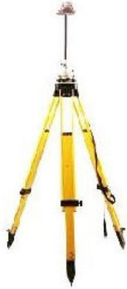
BASE ESTATICA / RTK
